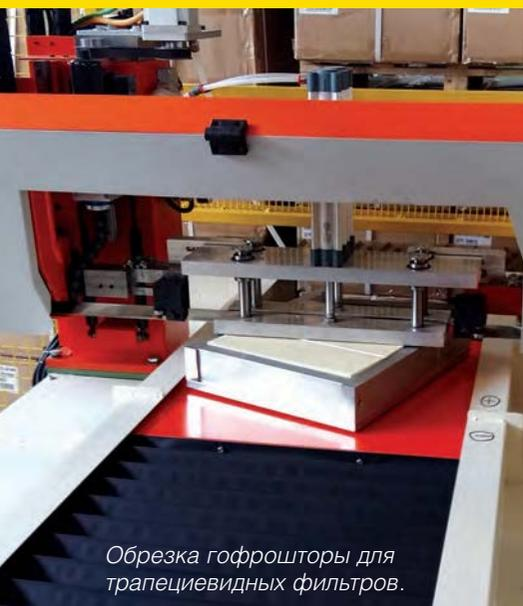
Обрезка гофрошторы для трапециевидных фильтров.
