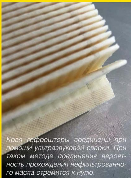
*Края гофрошторы соединены при помощи ультразвуковой сварки. При таком методе соединения вероятность прохождения нефилтрованного масла стремится к нулю.*
