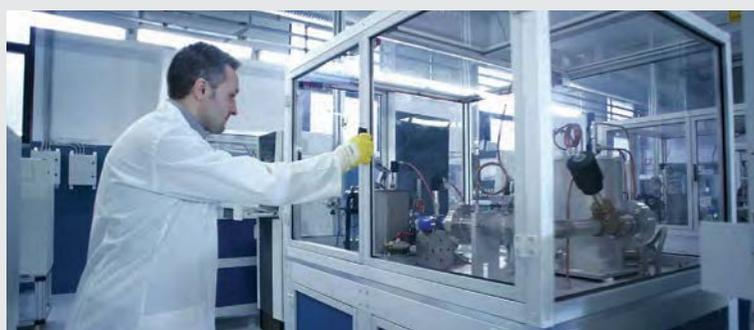
Помпы проверяются на воздействие агрессивных сред (бензин, масло, соляной раствор и пр.), измеряются производительность, виброустойчивость, работоспособность при температурах от  $-40^{\circ}\text{C}$  до  $+180^{\circ}\text{C}$ , проводится тест на протечку уплотнений, проверяется наработка на отказ.
