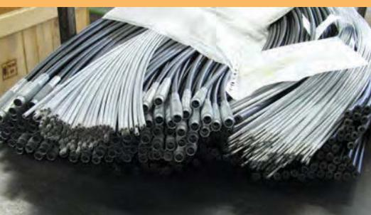
мо длины и типа соединения, должен соответствовать ряду спецификаций. Это и определенные коэффициенты гибкости/жесткости, усилия растяжения – хоть оно и почти незаметное, но его значение сказывается на том ощущении, которое возникает, к примеру, при переключении передач.
