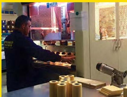
*Технология инфракрасной сварки для соединения гофрошторы с торцевым элементом картриджа уже несколько лет применяется на заводе TECNECO.*
