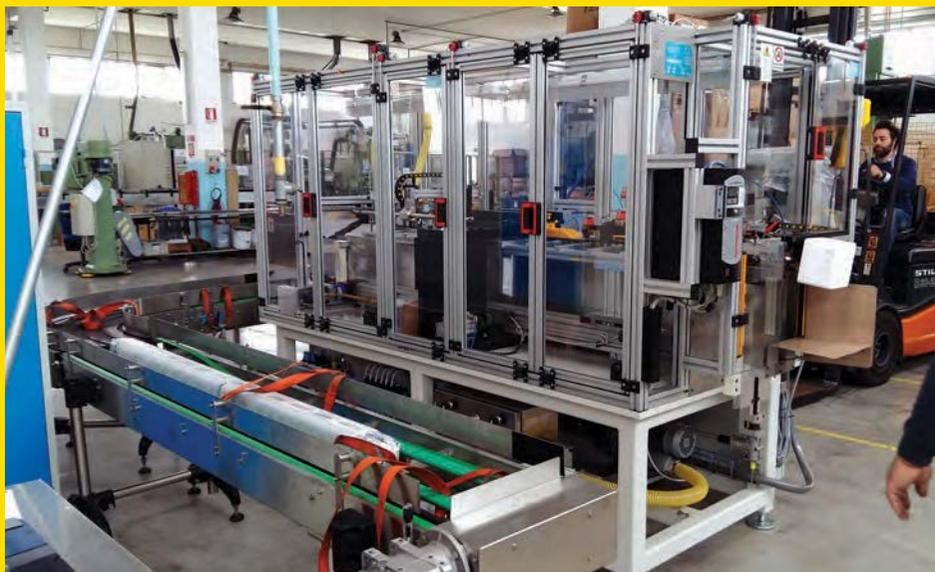
ке картриджа спин-он фильтра, когда гофроштора посредством герметика соединяется с торцевым элементом картриджа (производится из стали DX 53), обеспечивающего ее жесткость. Собранный картридж прогревается при температуре 170-180 градусов.
