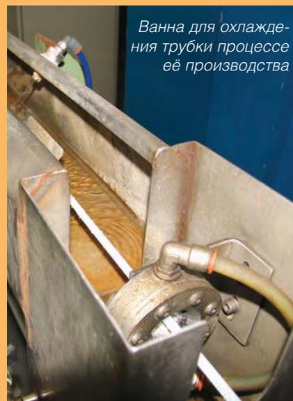
Ванна для охлаждения трубки процессе её производства
