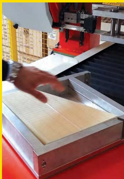
роштору клеевых перемычек – для фиксации шага (расстояния между складками). Когда нужное для конкретного фильтра количество складок сделано, клеевая полоска на пару складок прерывается. Так будет проще разрезать бесконечную гофроштору на части для отдельных фильтров. Возможно, это также делается для того, чтобы клей не попадал под полиуретановую рамку. Рамка контактирует только с фильтровальным материалом, он пористый и с ним получается хорошая адгезия (сцепление) полиуретана.
