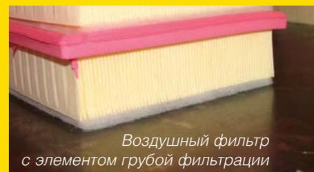
Воздушный фильтр с элементом грубой фильтрации
