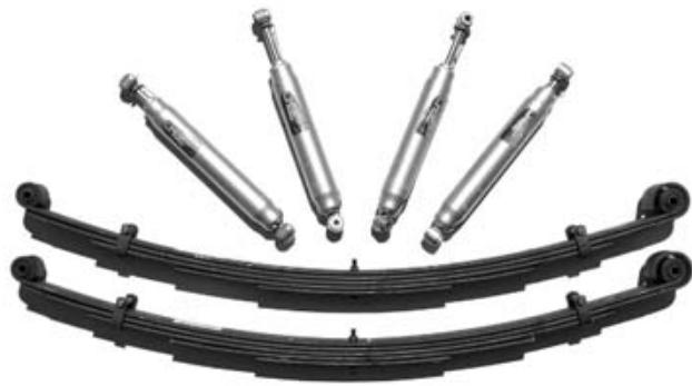
должны быть максимально длинными, поскольку возникающие в них напряжения обратно пропорциональны квадрату длины) и материалоемкость в сочетании с высокой технологической сложностью производства. Листы для рессор изготавливают из дорогой, высокопрочной стали, в состав которой входит и кремний, и марганец (55ГС, 55С2, 60С2), и хром, и никель (50ХГ). Предел текучести стали, идущей для изготовления листов рессор
