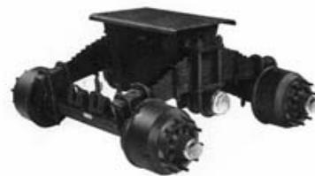
Двухосные балансируемые рессорные агрегаты типа "W"
