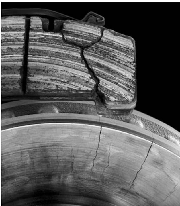
Разрушение фрикционного материала дешевых накладок приводит к разрушению тормоза.
