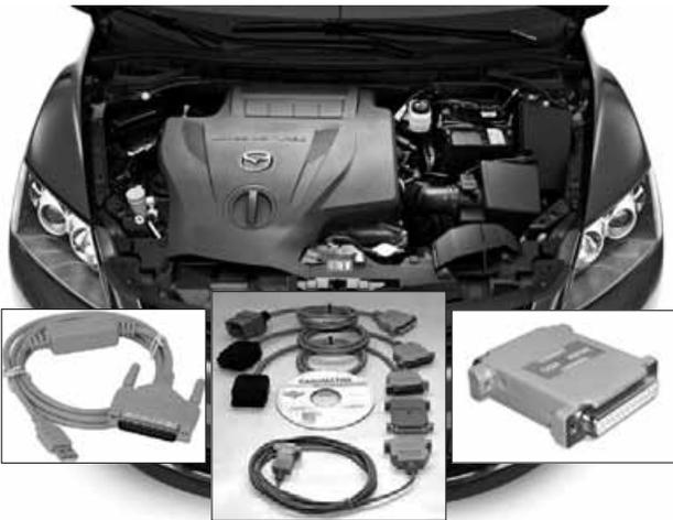
Чем совершеннее системы управления и дополнительные устройства, тем разнообразнее оборудование для диагностики. Для считывания кодов неисправностей и контроля параметров необходим сканер.
