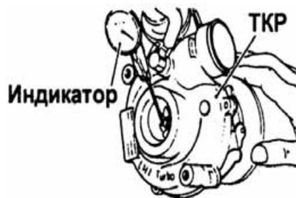
Рис. 6. Измерение люфтов ТКР
