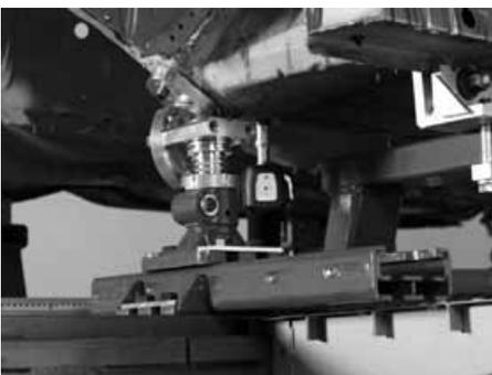
и включает: две дополнительные башни и направляющие пластины, специальные приспособления для задней оси автомобиля, удлинители для распорки и регулируемые фиксаторы.
