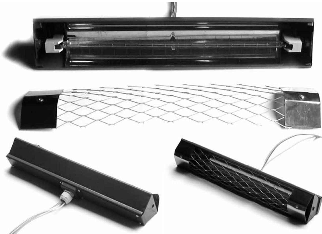
*В сегодняшнем варианте ИК-сушек, производимых «Автоколоритом», основой источника термоизлучения служит ИК-модуль, содержащий лампу КГТ 220-1000-1 в сочетании с отражателем, имеющим профиль, приближенный к параболическому. Такое решение позволяет в перспективе создавать термопанели различного пространственного охвата для разнообразнейшего применения ИК - нагрева в различнейших областях хозяйствования.*
