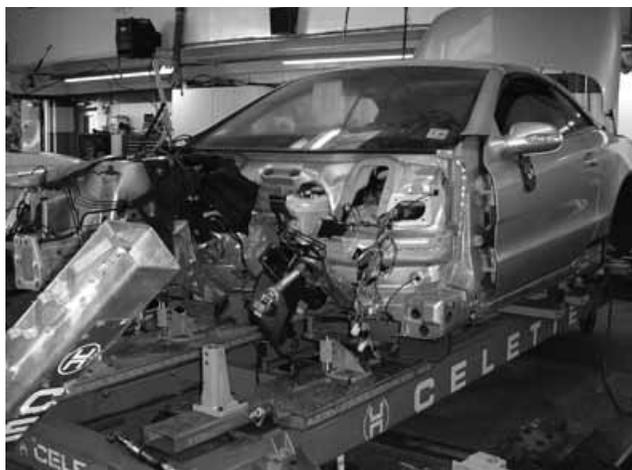
Кузов автомобиля закрепляется зажимами за отбортовку порогов кузова под краями кабины. К зажимным губкам прикреплена пластина с вырезом (одна или две с каждой стороны автомобиля). В отверстия пластин вставляют трубу и устанавливают ее на подставки. Цепи равномерно соединяют с башмаками, закрепленными на металлической раме, что препятствует опрокидыванию кузова со стендом в процессе растяжки.
