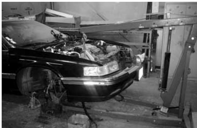
Чтобы быть уверенным в том, что впоследствии не произойдет обратных перемещений выправленных участков кузова, обусловленных остаточными напряжениями, выстукивание поверхности производят через деревянную подкладку в направлении удара. Если при этом выпрямленный кузов не изменяет свою форму, то операция правки выполнена правильно. В противном случае следует снова произвести правку до получения геометрии в пределах допусков, установленных изготовителем автомобиля.
