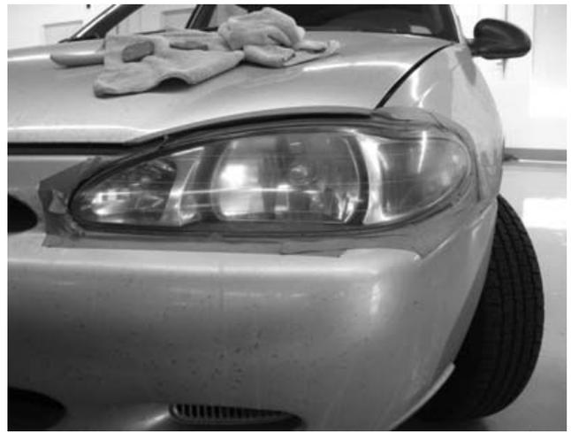
*В большинстве случаев достаточно оклеить прилегающие к фаре поверхности автомобиля (кромки бампера, крыльев, решетки радиатора) бумажным либо малярным скотчем. Нужно учитывать, что оклейку нужно делать в несколько слоев, чтобы не повредить поверхности в процессе работы полировальной машинкой.*
