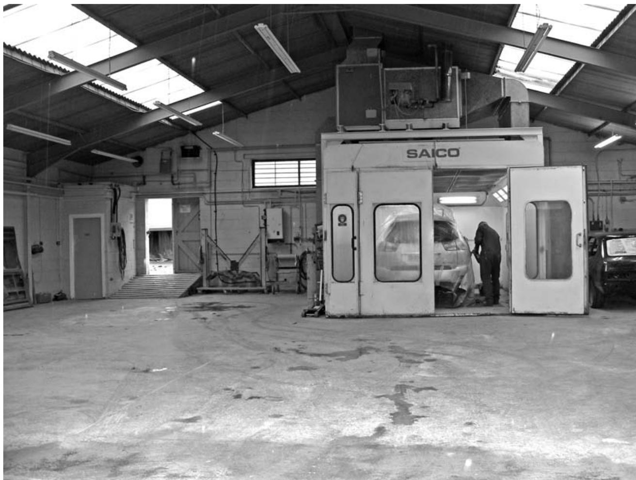
Исходя из усредненных размеров автомобиля 4,2x1,7 м и необходимости обеспечения достаточно-го для проведения работ пространства, размеры каждого рабочего поста должны быть не менее 7 м в длину и 4 – в ширину.
