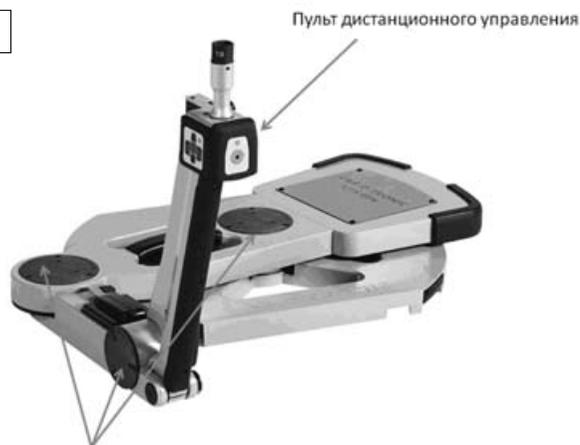
Сенсоры, расположенные в шарнирных соединениях, передают данные в режиме реального времени 3 раза в секунду
