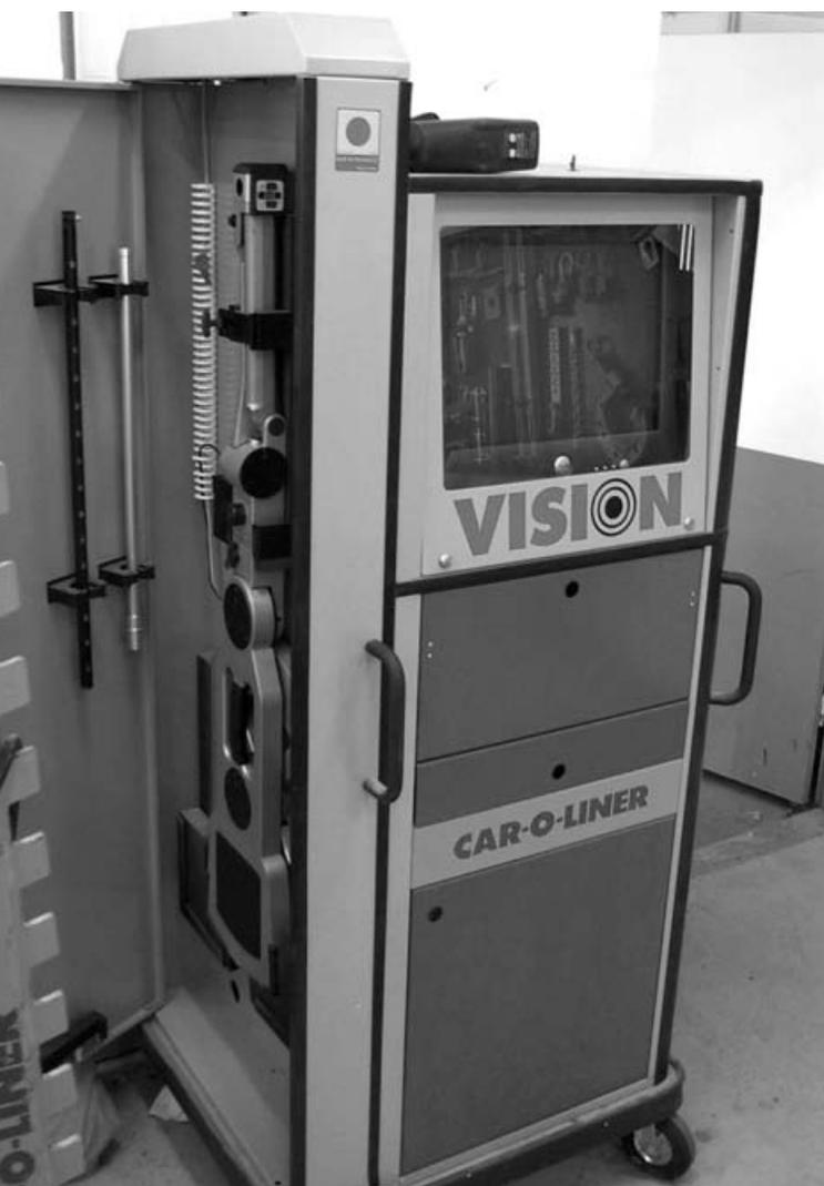
Измерительная система играет важнейшую роль в процессе восстановительного ремонта автомобиля. При отклонениях геометрических размеров кузова от номинальных значений изменяются различные параметры и характеристики транспортного средства. Чтобы гарантировать соответствие восстановленного кузова новому по геометрическим параметрам, необходимо иметь оборудование, способное контролировать весь процесс ремонта - от диагностики повреждений до контроля качества выполненных работ.
