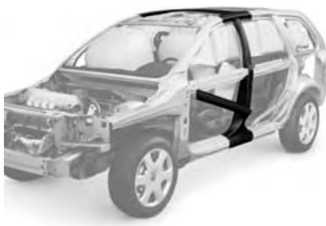
Рис. 1. Volvo XC90 стал одним из первых автомобилей, при изготовлении которого использовалась сверхвысокопрочная сталь. Ею усилены центральные стойки и поперечины кузова автомобиля (на иллюстрации эти места выделены темным).
