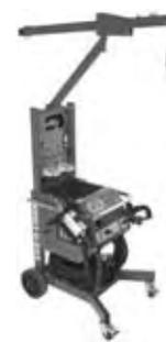
Рис. 4: Данный аппарат для контактной точечной сварки обжимного типа имеет специальную программу для сварки UHSS.
