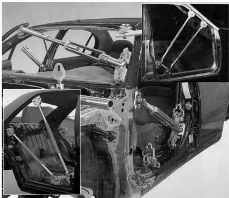
*Рис.3. Крепления применяется для удерживания конструкции. Это помогает снизить вероятность повреждения целых деталей во время выравнивания кузова.*
