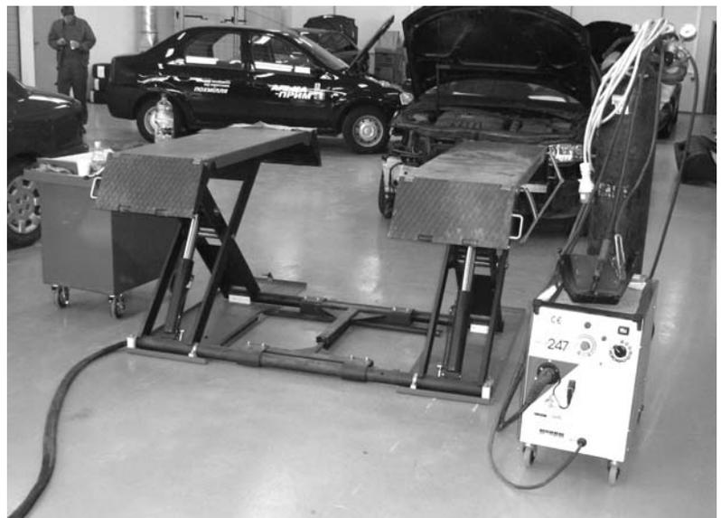
средства на специальной тележке. Обеспечение рабочего места электроэнергией, сжатым воздухом, вентиляцией осуществляется в рамках организации всего производства из централизованных источников.
