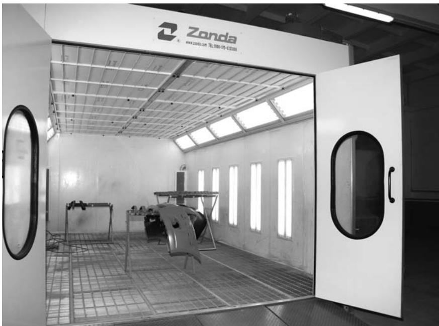
Окраска/сушка проводится в камере Zonda, позволяющей работать как с сольвентными материалами, так и с материалами на водной основе. Для ускорения процессов ремонта также применяются современные инфракрасные лампы.
