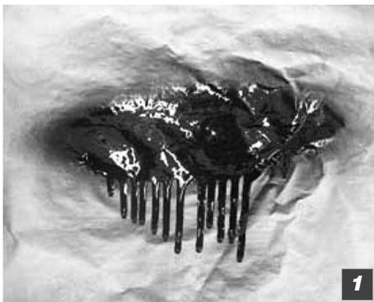
Фото 1. Тест на равномерность распределения краски в факеле.
